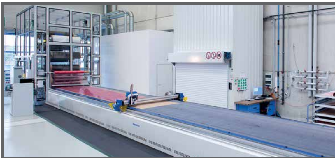
Odvíjecí zařízení instalované před stříhacím zařízením.
